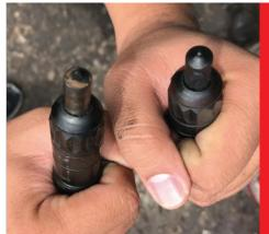
DIESEL ENGINE FUEL INJECTOR:
